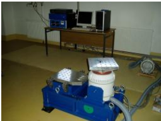
Zariadenie pre skúšky vibrácií
