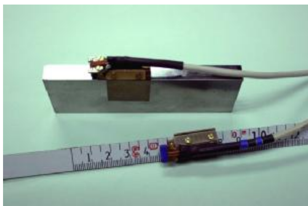
Ukážka vytvorenia snímačov teploty koncovej mierky a meračského pásma.
