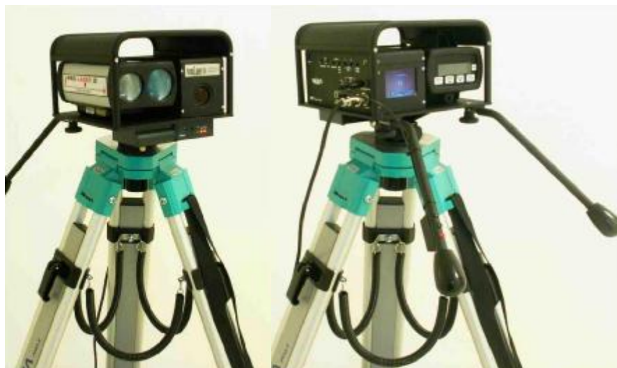
Laserové meradlo rýchlosti pre použitie v cestnej premávke – nový odbor kalibrácií v C210.
