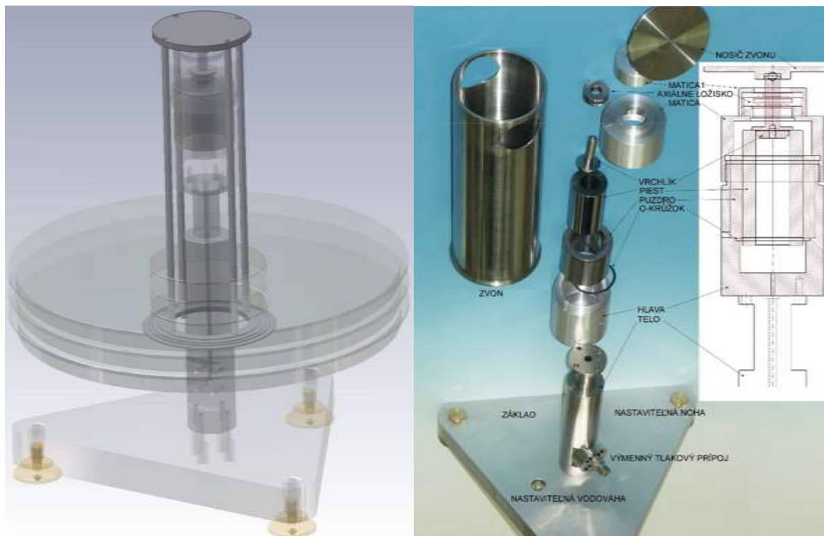
Obr. 5 CAD Model NE tlaku a praktická realizácia uchytenie tlakovej mierky s efektívnou plochou 10 cm. 2
