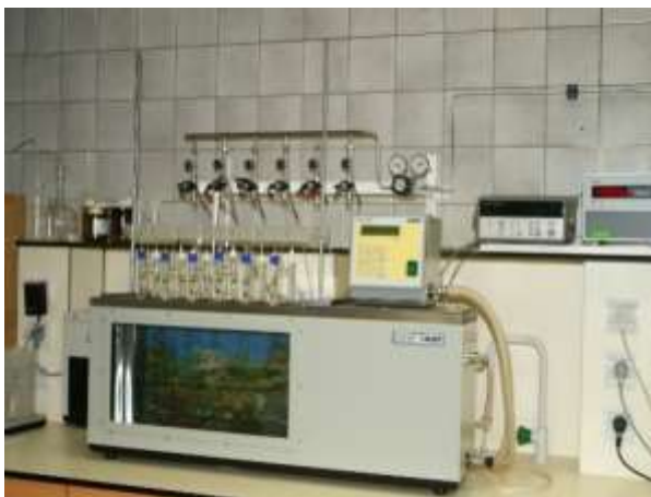
Obr. 11 - Zostava Národného etalónu pH
