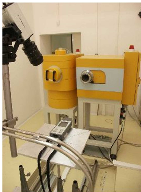
Kalibrácia dozimetra v ^{137}\text{Cs} referenčnom fotónovom zväzku.
