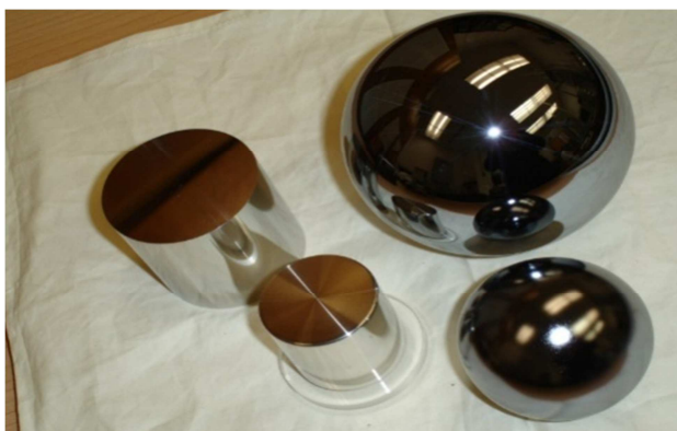
OCEĽOVÝ ETALÓN 1 KG, PTÍR ETALÓN 1 KG NO 41, KREMÍKOVÉ GULÔČKY 1 KG A 240 G -POUŽÍVANÉ AKO ETALÓNY HUSTOTY, GULÔČKY 1 KG SA BUDÚ POUŽÍVAŤ AKO ETALÓNY HMOTNOSTI
