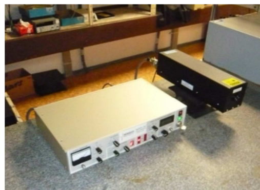
LASER SMU-1 SO STABILIZAČNOU ELEKTRONIKOU
