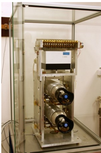
Obr. 8 - Automatický systém na váženie tlakových nádob
