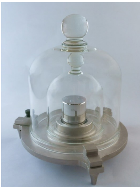
Obr. 1 - Kópia medzinárodného prototypu Ptlr kilogramu č. 65, súčasť NE hmotnosti
