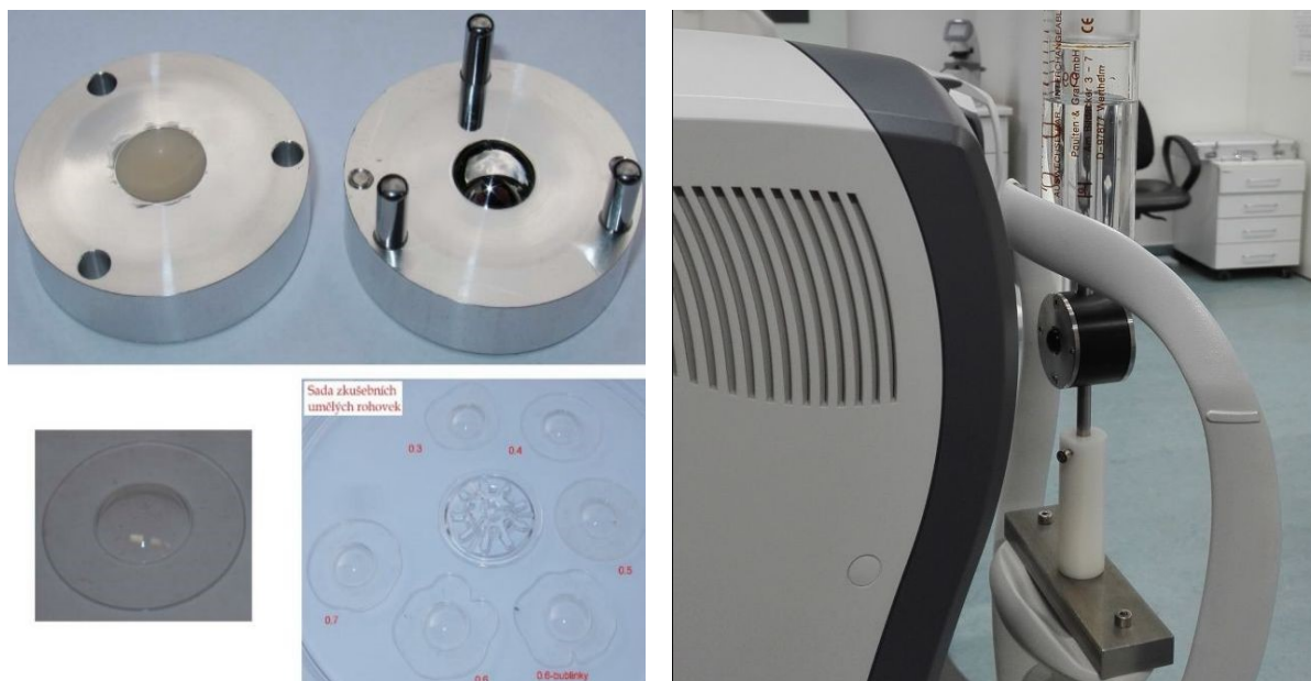
Obr. 7 - Forma na lisovanie umelej rohovky a uchytenie umelého oka pri kalibrácii očného tonometra
