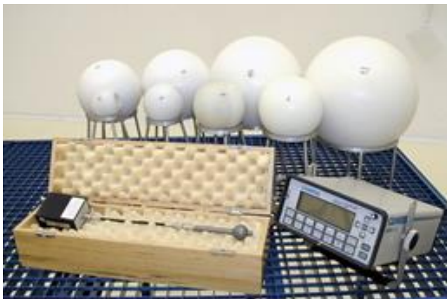
POLYETYLÉNOVÉ SFÉRY BONNEROVHO SPEKTROMETRA
