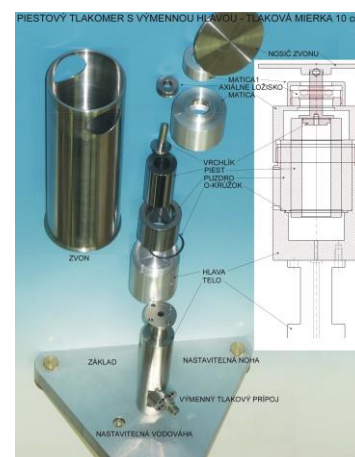
JEDNO Z RIEŠENÍ PIESTOVÉHO TLAKOMERA
