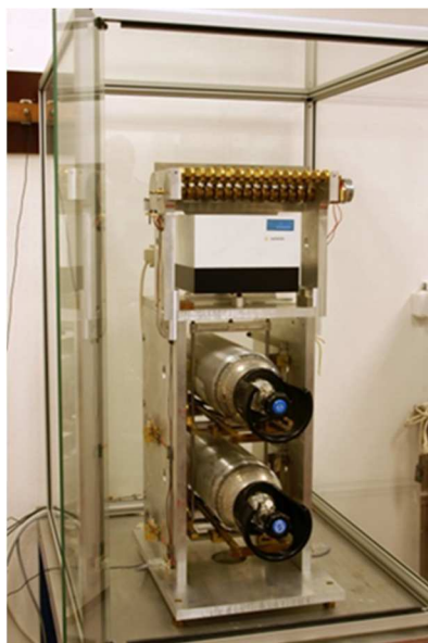
Obr. 9 - Automatický systém na váženie tlakových nádob
