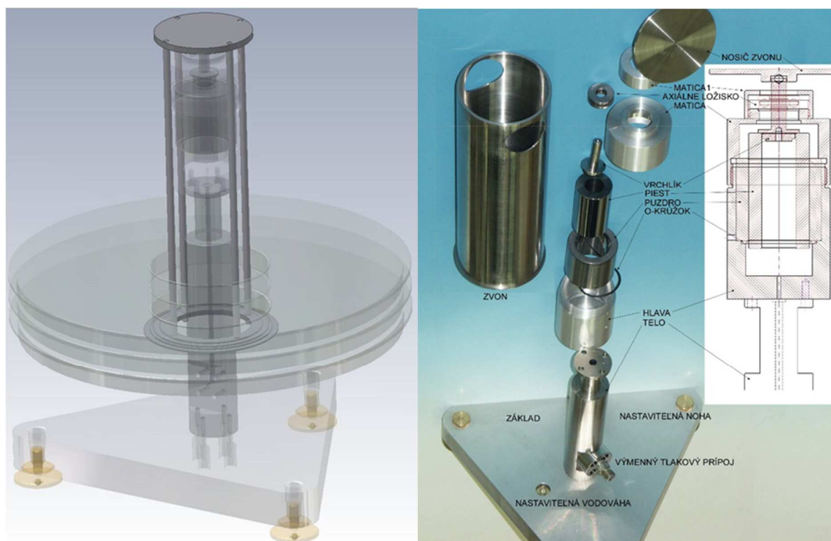
Obr. 6 CAD Model NE tlaku a praktická realizácia uchytenie tlakovej mierky s efektívnou plochou 10 cm. 2
