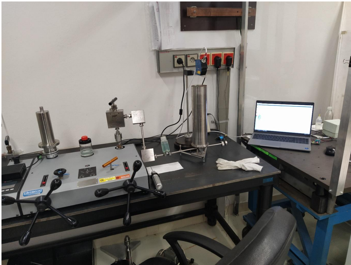
Obr. 4 - Pracovisko pri porovnávacom meraní piestových tlakomeroch do 1 GPa.
