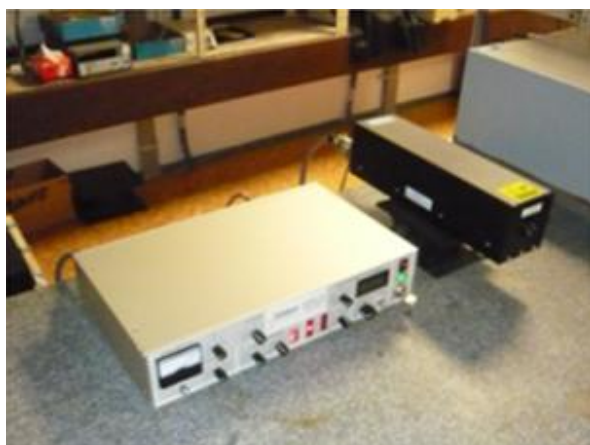
Obr. 1 - Jódom stabilizovaný HeNe laser SMÚ-1
