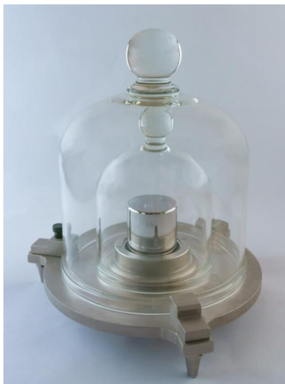
KÓPIA MEDZINÁRODNÉHO PROTOTYPU PTIR KILOGRAMU NO 65, SÚČASŤ NE HMOTNOSTI
