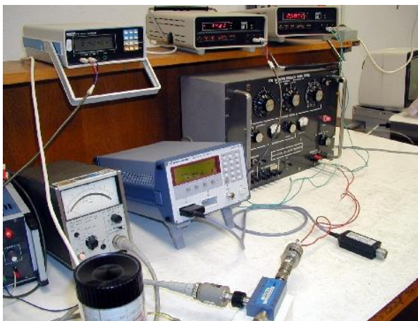
ČASŤ ZOSTAVY ETALÓNU VYSOKOFREKVENČNÉHO VÝKONU
