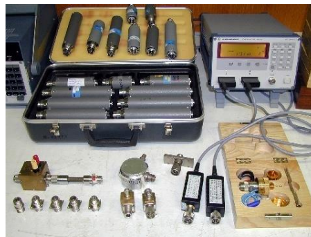
ZARIADENIE NÁRODNÉHO ETALÓNU VYSOKOFREKVENČNÉHO NAPÄTIA
