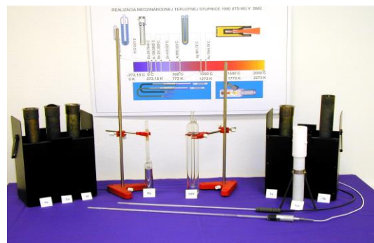
PRIMÁRNE DEFINIČNÉ PEVNÉ BODY A ETALÓNOVÉ ODPOROVÉ SNÍMAČE TEPLoty
