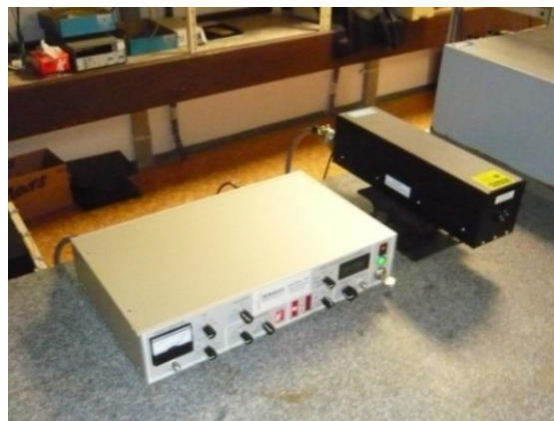
LASER SMU-1 SO STABILIZAČNOU ELEKTRONIKOU
