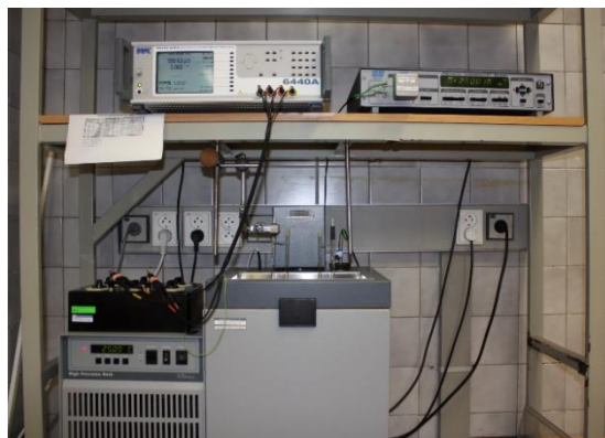
ZOSTAVA NE ELEKTROLYTICKEJ KONDUKTIVITY
