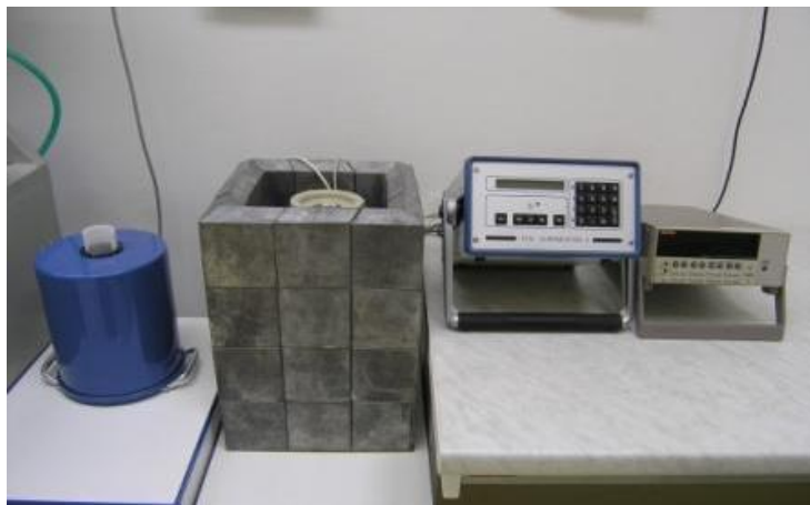
STUDNICOVÉ TLAKOVÉ IONIZAČNÉ KOMORY
