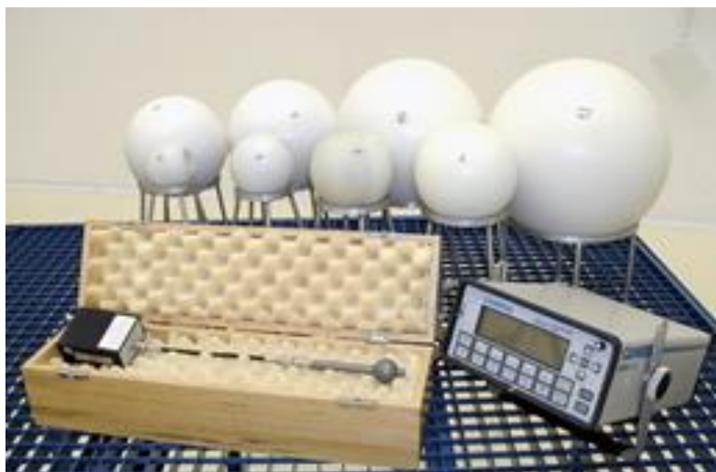
POLYETYLÉNOVÉ SFÉRY BONNEROVHO SPEKTROMETRA
