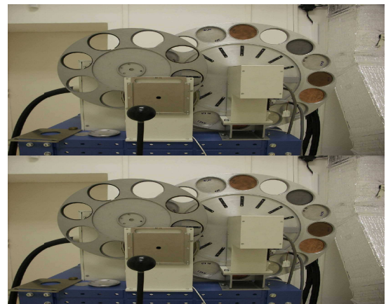
Etalónová ionizačná komora a generátor rtg. žiarenia s energetickými filtermi a clonami
