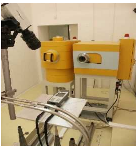
Kalibrácia dozimetra v ^{137}\text{Cs} referenčnom fotónovom zväzku.
