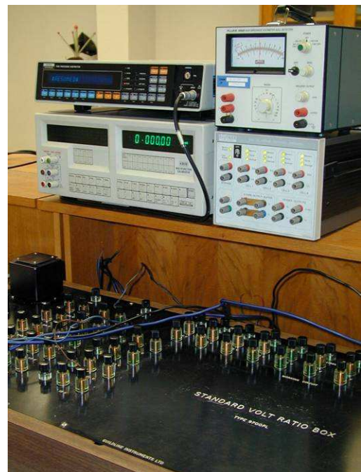
Časť národného etalónu jednosmerného napätia (stupnica do 1000 V)
