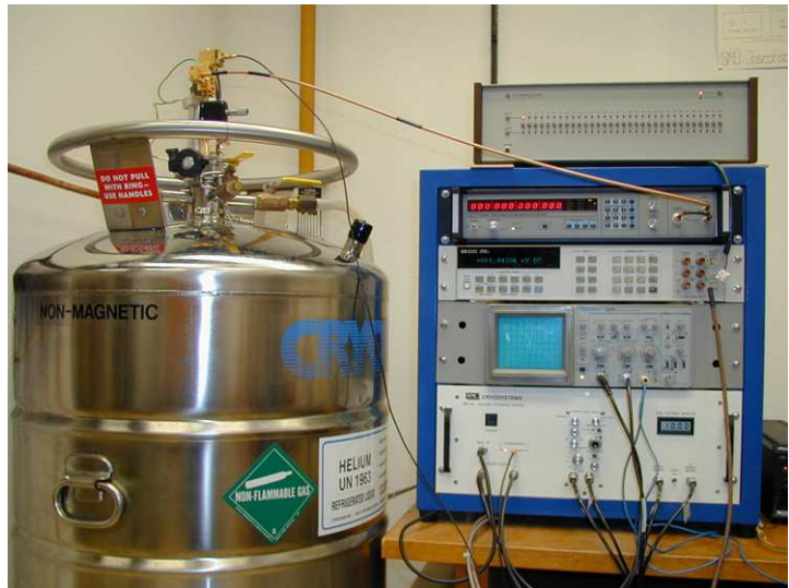
Národný etalón jednotky jednosmerného napätia – primárny etalón na báze Josephsonovho javu
