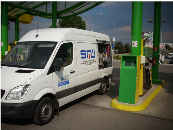
Pojazdné laboratórium SMÚ na overovanie výdajných stojanov na pohonné hmoty
