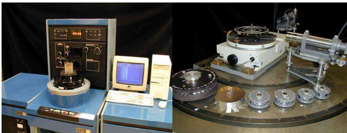
Laserový goniometer - časť národného etalónu rovinného uhla
