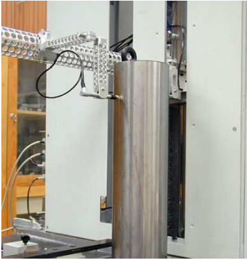
Etalónové zariadenie na kalibráciu uholníkov pri kalibrácii valcového uholníka
